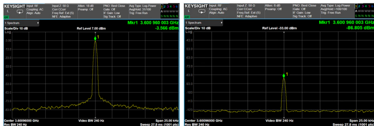
图 35 TX1 至 TX2 隔离度 (TX LO=3600M)
